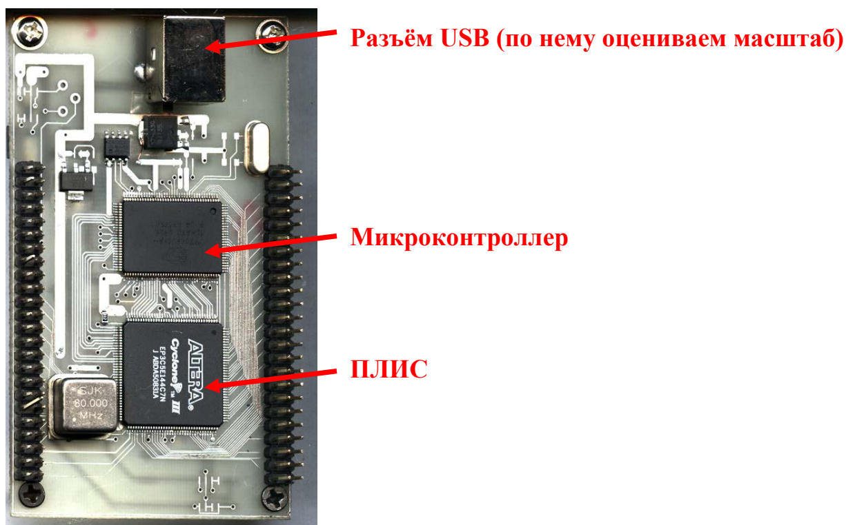
Рисунок 1. Основная плата Cassel Aero (я постарался сделать масштаб 1:1)
