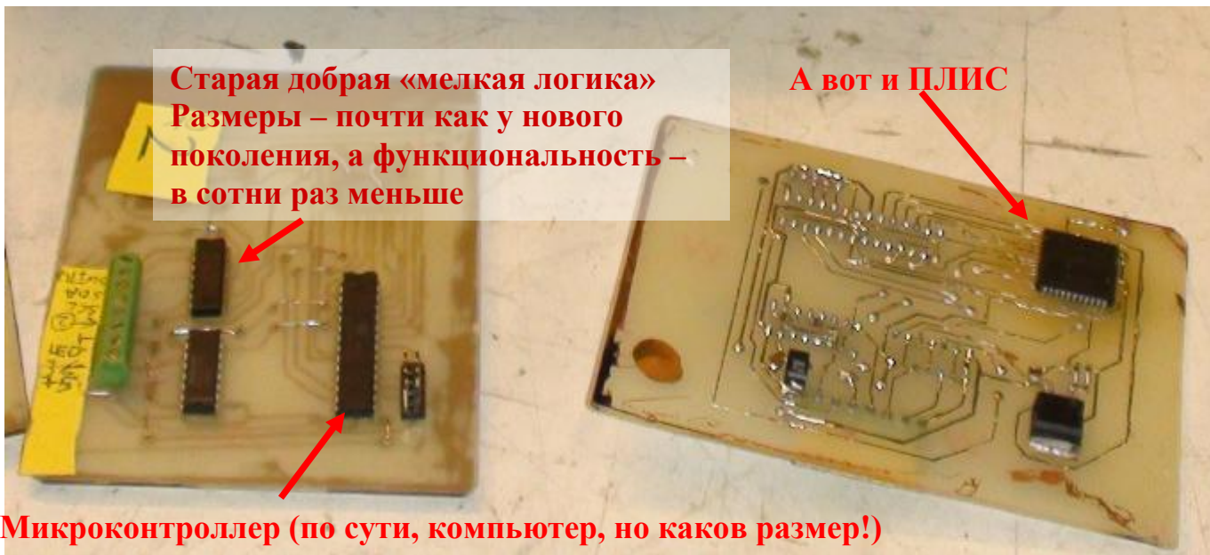
Рисунок 2. Модуль весов (масштаб почти 1:1)
